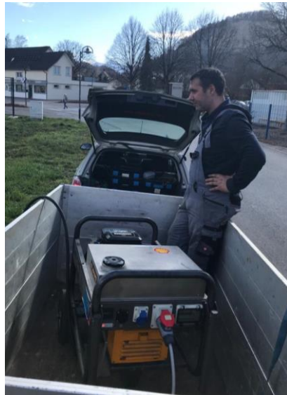
Notstrom-Maßnahmen bei den Pumpstationen (ARA ist schon mit 800kVA Notstrom-Aggregat versorgt)
